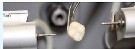
Das fertig gefräste Werkstück
